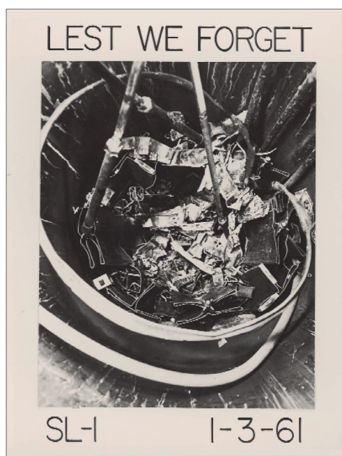
損傷した SL-1 炉心
