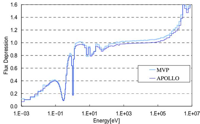
図 4 APOLLO 法による兵器級プルトニウム粒子内の Flux Depression
