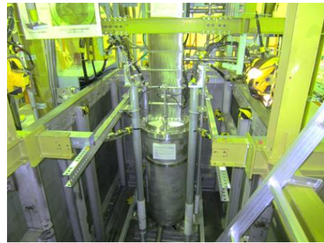
写真1 溶液系STACYの炉心タンク(更新改造前)
