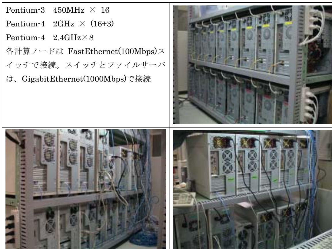
図 21 第 3 世代の PC クラスタの構成
