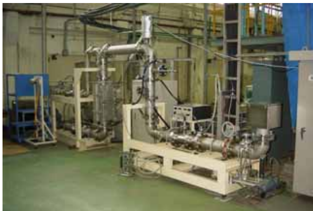
図 2 火災時ソースターム試験装置
