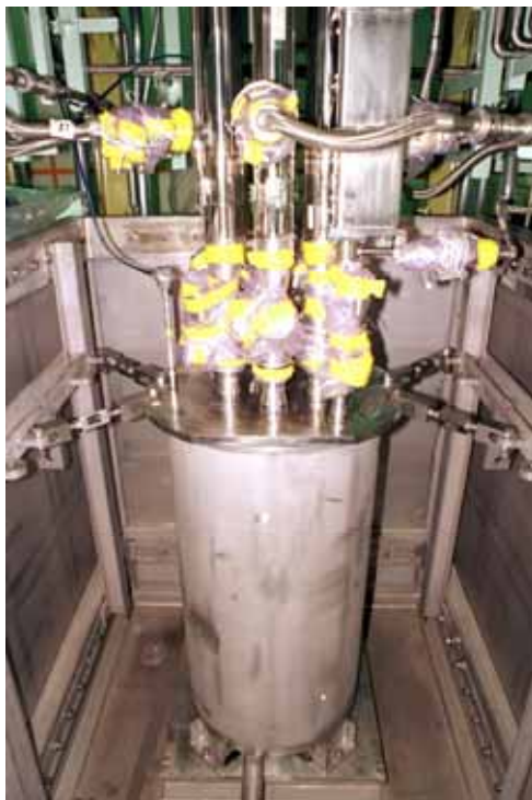
図 1 STACY の炉心タンク
